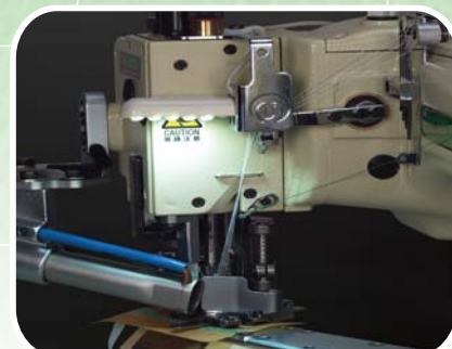
附自動照明功能(伺服馬達系列)。 Includes LED light(For servo motor models).
